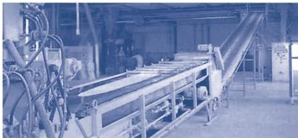
Extruderanlage mit Kühlband
